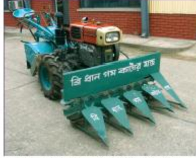
চিত্র ৬০। পাওয়ার টিলার চালিত ব্রি ধান-গম কাটা যন্ত্র।
