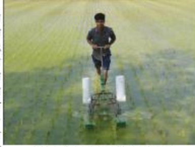
চিত্র ৫৭। ত্রি দানাদার ইউরিয়া প্রয়োগ যন্ত্র।
