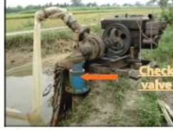
চিত্র ৮। অগভীর নলকূপে চেক ভান্ডের ব্যবহার।
