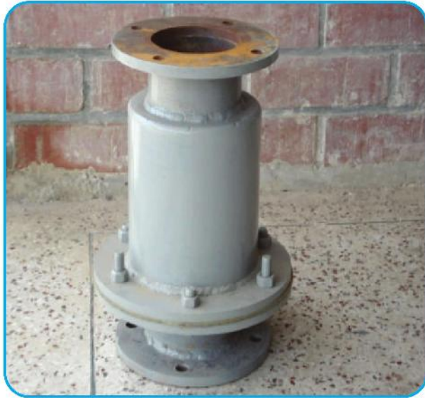
চিত্র: একটি চেক ভাল্ব (ফ্লেঞ্জ সিস্টেম)
