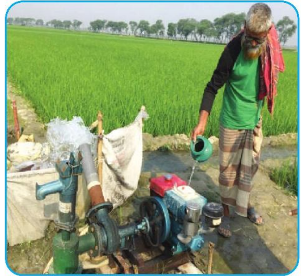
চিত্র: চেক ভাল্ব স্থাপনকৃত একটি শ্যালো টিউবওয়েল
