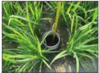
চিত্র ১১। এড্রিউজি পদ্ধতিতে পাইপে পানি পর্যবেক্ষণ।
