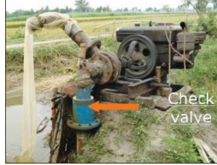
চিত্র ১৪। অগভীর নলকূপে চেক ভাল্বের ব্যবহার।
