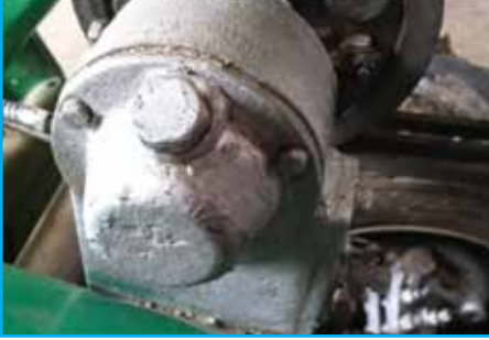
চিত্র ৮ ট্রান্সমিশন চেইনের টেনশন সমন্বয়
