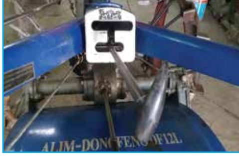
চিত্র ১৩ কন্ট্রোল (গিয়ার শিফ্টিং) লিভার নিউট্রাল পজিশনে
