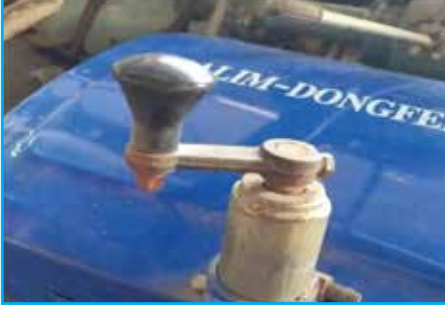
চিত্র ৩ চাষের গভীরতা সমন্বয়
