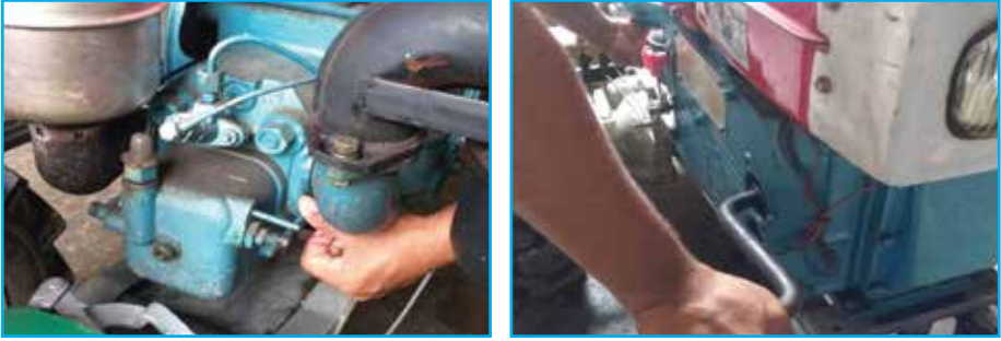
চিত্র ২২ ডিকম্প্রেশন লিভারে চাপ দিয়ে হাতল ঘুরানো
