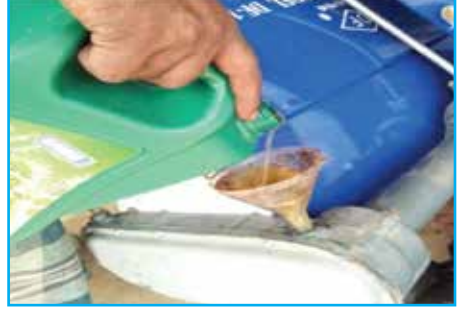
চিত্র ৭খ ট্রান্সমিশন বক্সে গিয়ার অয়েল ঢালা
