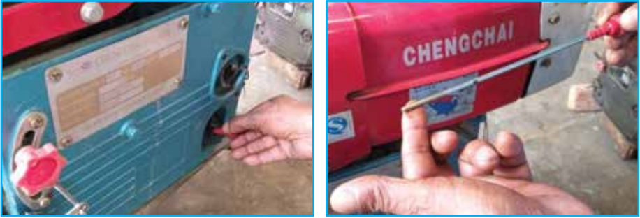
চিত্র ৩ লুব অয়েলের পিচ্ছিলতা ও পরিমাণ চেক করা
