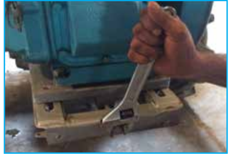
চিত্র ২ ভি-বেল্টের টেনশন সমন্বয়
