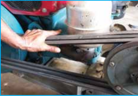
চিত্র ২ ভি-বেল্টের টেনশন সমন্বয়
