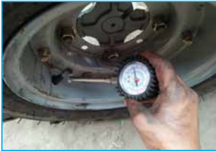
চিত্র ৯ চাকায় বাতাসের চাপ পরীক্ষা
