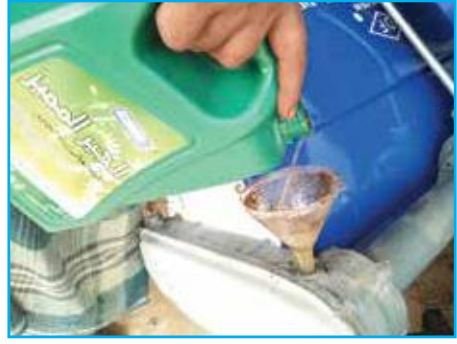
রোটোরি ট্রান্সমিশন গিয়ার বক্সে ট্রান্সমিশন অয়েল ঢালা
