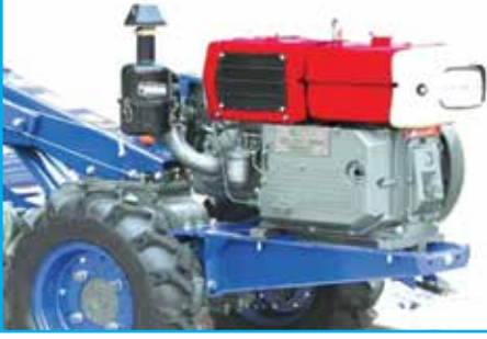
চিত্র ১ চেসিসে ইঞ্জিনের অবস্থান সমন্বয়
