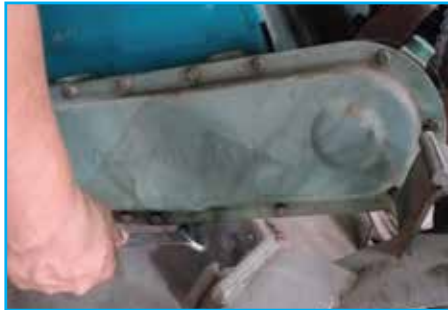
চিত্র ৯ ট্রান্সমিশন চেইনের টেনশন সমন্বয়
