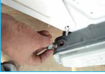
চিত্র ৭খ ট্রান্সমিশন বক্সে গিয়ার অয়েল ঢালা
