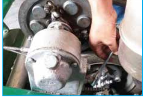
চিত্র ৮ ট্রান্সমিশন চেইনের টেনশন সমন্বয়
