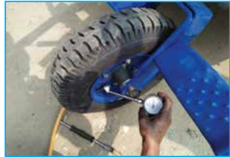
চিত্র ৯ চাকায় বাতাসের চাপ পরীক্ষা
