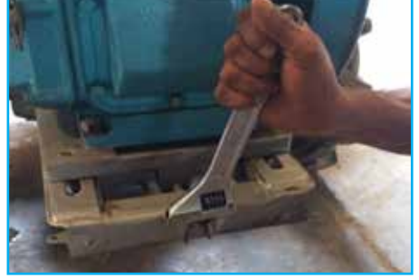
চিত্র ১ চেসিসে ইঞ্জিনের অবস্থান সমন্বয়
