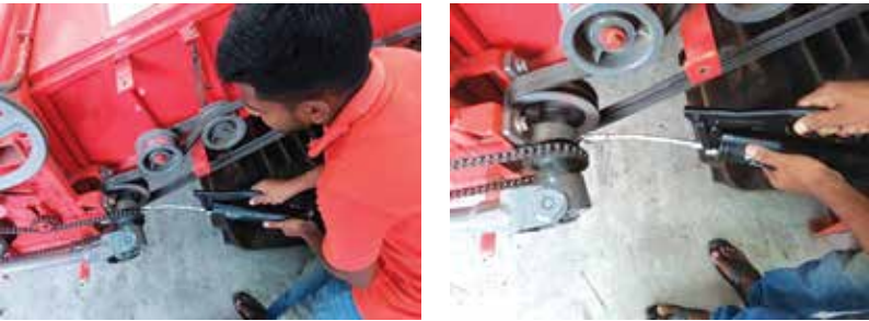
চিত্র ১২ কনভেয়ার বক্স থেকে হেডার ইউনিট এর পাওয়ার ট্রান্সমিশন শ্যাফট-এ ইউসিপি বেয়ারিং
