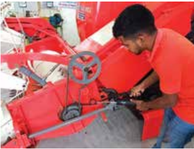
চিত্র ৩ স্ট্র ড্রাম এর চেইন
