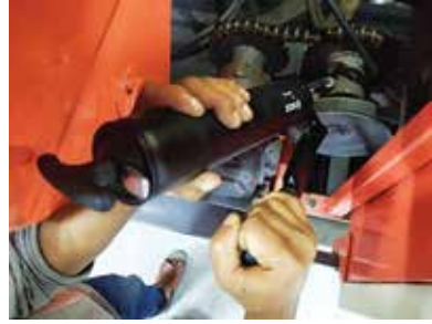
চিত্র ১৪ ইঞ্জিন থেকে গ্রেইন ট্যাংকে পাওয়ার আসার ট্রান্সমিশন শ্যাফটের ইউসিপি বেয়ারিং
