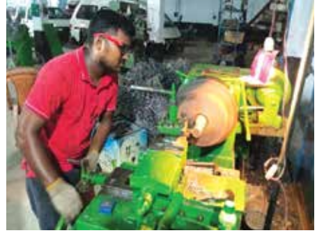
চিত্র ৩২ লেদে থ্রেসিং রোলারের পাইপ তৈরি হচ্ছে
