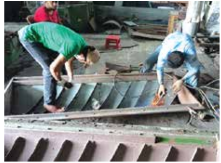
চিত্র ৪০ টপ কভারে সিট ওয়েল্ডিং করা হচ্ছে
