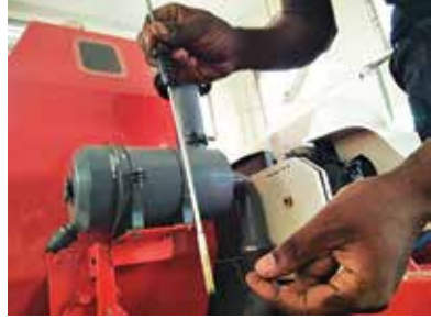
চিত্র ১ ইঞ্জিন অয়েলের পিচ্ছিলতা পরীক্ষা করা ও অয়েল ভরা
