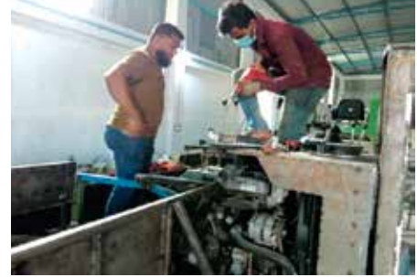
চিত্র ১৪ ড্যাশ বোর্ডে পাওয়ার লাইনের জন্য ড্রিল করা হচ্ছে
