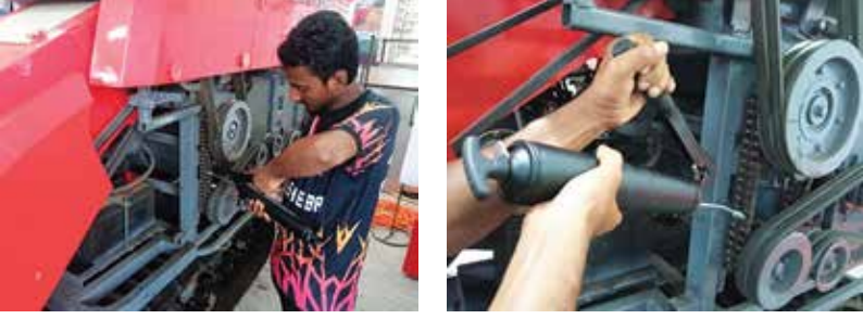
চিত্র ১০ ইঞ্জিন থেকে থ্রেসিংয়ের পাওয়ার ট্রান্সমিশন শ্যাফটের ইউসিপি বেয়ারিং
