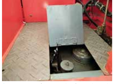
চিত্র ৫ ড্যাশবোর্ডের বেইজমেন্টের ক্লিনআউট পকেট
