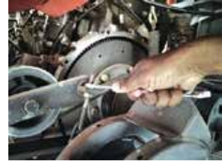
চিত্র ২৩ বেল্ট টেনশন হুইল সমন্বয়
