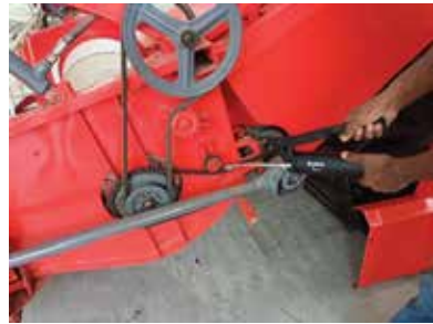
চিত্র ৩ স্ট্র ড্রাম এর চেইন
