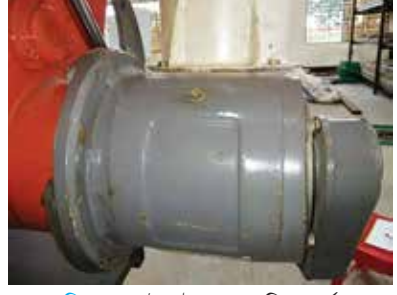
চিত্র ৮ গ্রেইন ট্যাংকের ডিসচার্জ অগারের ক্লিনআউট পকেট
