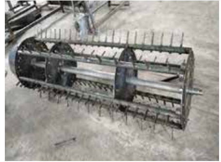
চিত্র ৩৪ থ্রেসিং রোলার তৈরি হচ্ছে
