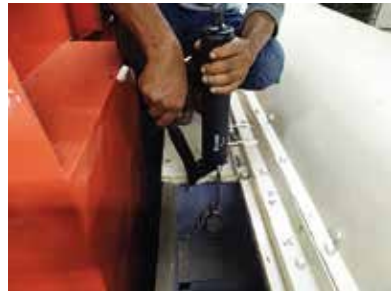
চিত্র ১৫ থ্রেসার ড্রাম রিসাইকেল ইউনিটের শ্যাফটের ইউসিপি বেয়ারিং
