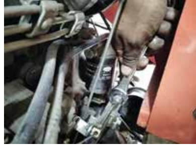
চিত্র ১৫ পুল টু টার্ন অফ সুইচ সমন্বয়
