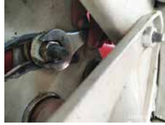
চিত্র ৭ রিল টুথ সমন্বয়
