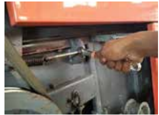
চিত্র ২৪ থ্রেসিং ড্রাম ড্রাইভ বেল্ট সমন্বয়
