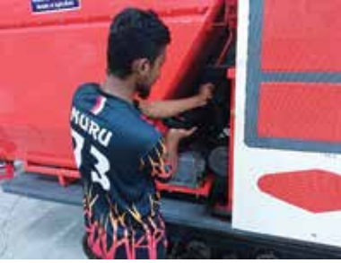
চিত্র ১৪ ইঞ্জিন থেকে গ্রেইন ট্যাংকে পাওয়ার আসার ট্রান্সমিশন শ্যাফটের ইউসিপি বেয়ারিং
