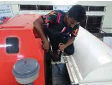
চিত্র ১৫ থ্রেসার ড্রাম রিসাইকেল ইউনিটের শ্যাফটের ইউসিপি বেয়ারিং
