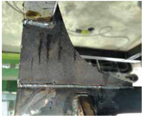
চিত্র ৪ সাপোর্ট প্লেটে মিগ ওয়েল্ডিং করা হচ্ছে
