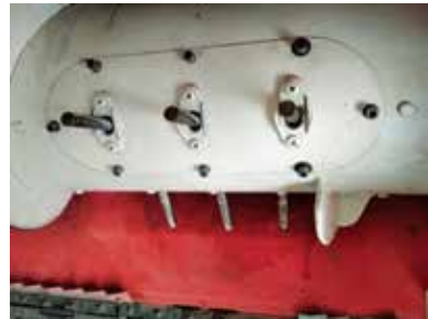
চিত্র ৪ কাটিং অগার ড্রাম ক্লিনআউট পকেট
