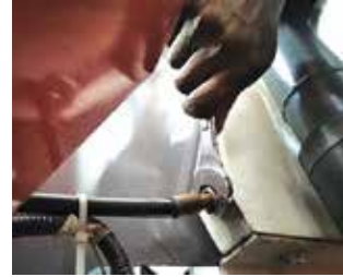
চিত্র ৩ গ্রেইন ডিসচার্জ লিভার সমন্বয়
