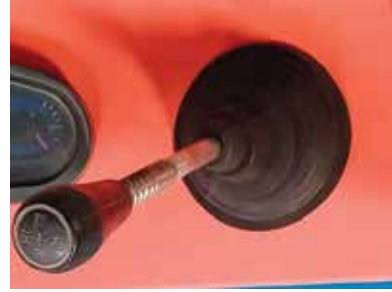
চিত্র ১১ হেডার এনগেইজমেন্ট কন্ট্রোল লিভার
