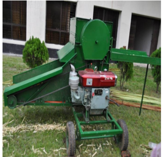
চিত্র-৭: পাটের রিবনিং করার জন্য Auto Jute Power Ribboner
