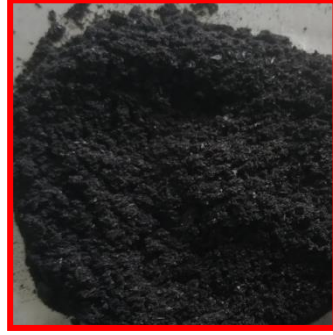
চিত্র-৩ পাট কাঠি হতে উৎপাদিত চারকোল ও সক্রিয় কার্বন
