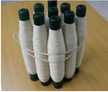
চিত্রঃ পাট, তুলা, দেশী ভেড়ার পশম ও এক্রাইলিক-এর মিশ্রণে উদ্ভাবিত সূতা (রিং স্পিনিং)
