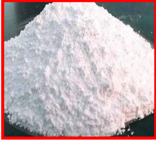
চিত্র-১ পাট হতে উৎপাদিত মাইক্রোক্রিস্টালাইন সেলুলোজ
