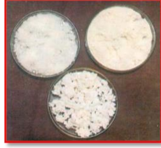
চিত্র-২ পাট হতে উৎপাদিত পাল্প ও পেপার
