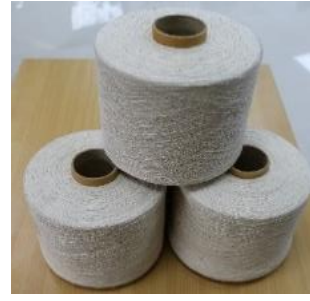
চিত্রঃ পাট, তুলা, দেশী ভেড়ার পশম ও এক্রাইলিক-এর মিশ্রণে উদ্ভাবিত সূতা (রোটর স্পিনিং)
