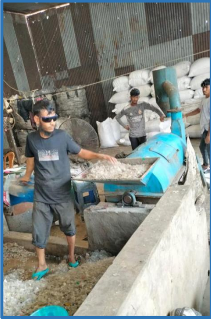
চিত্রঃ কারখানাতে শ্রমিকগণ পেট বোতল থেকে ফ্লেক্স তৈরি করছেন
