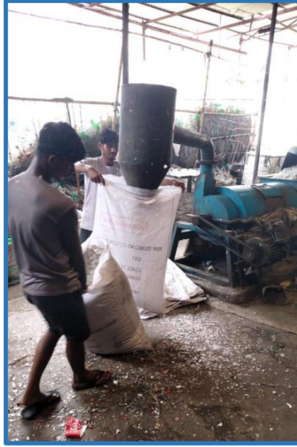
চিত্রঃ কারখানাতে শ্রমিকগণ পেট বোতল থেকে ফ্লেক্স তৈরি করছেন
