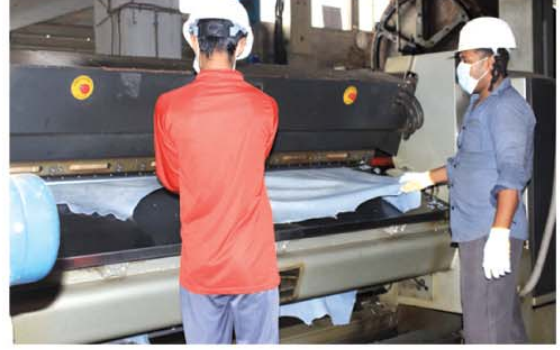
চিত্র: ওয়েট ব্রু চামড়ার স্প্লিটিং করা হচ্ছে।
