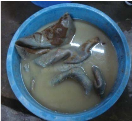
চিত্র: প্লাস্টিক বোলে একটি চামড়ার লাইমিং চলছে।
