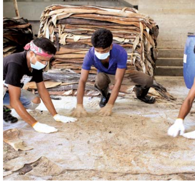
চিত্র: গরুর কাঁচা চামড়ায় লবণ প্রয়োগ পদ্ধতি
