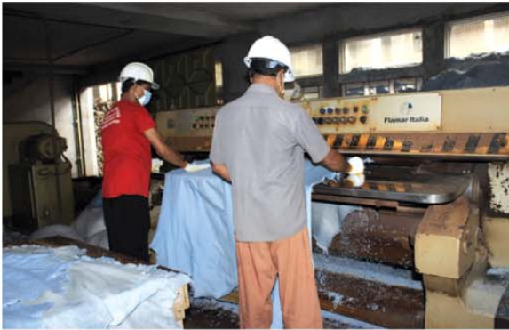
চিত্র: ওয়েট ব্রু চামড়ার শেভিং অপারেশন।
