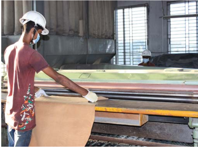
চিত্র: চামড়ার বাফিং অপারেশন
