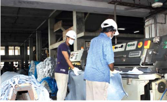
চিত্র: ওয়েট ব্রু চামড়ার স্প্লিটিং করা হচ্ছে।
