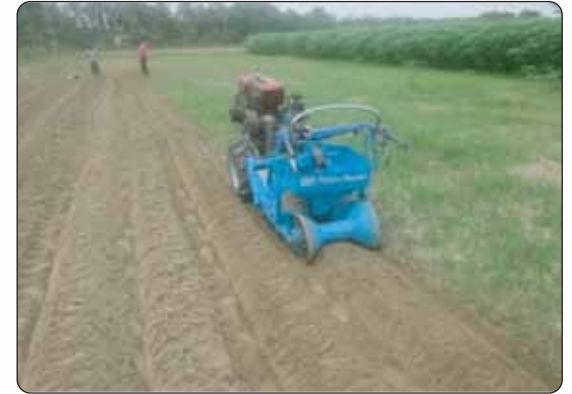
চিত্র ২: পাওয়ার টিলার চালিত বারি আলু রোপণ মেশিন
