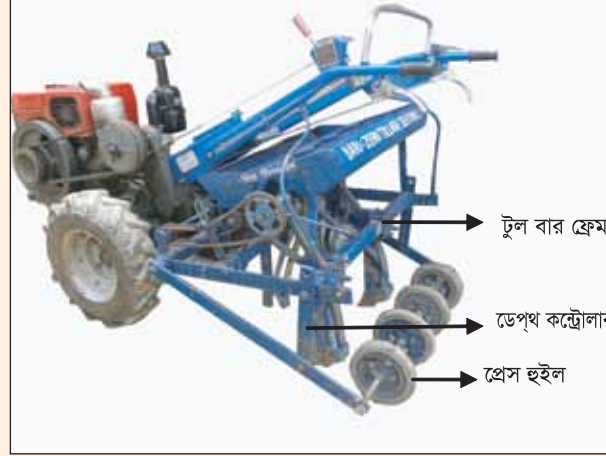
চিত্র: খ- বারি জিরো টিল সিডার যন্ত্রের বিভিন্ন অংশ
