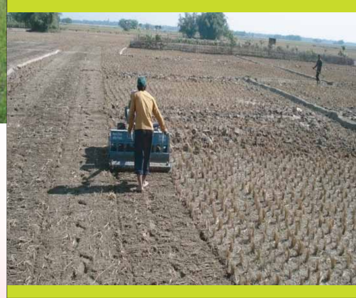
চিত্র ২: পাওয়ার টিলার চালিত বপন যন্ত্রের মাধ্যমে বপনকৃত গমের জমি
